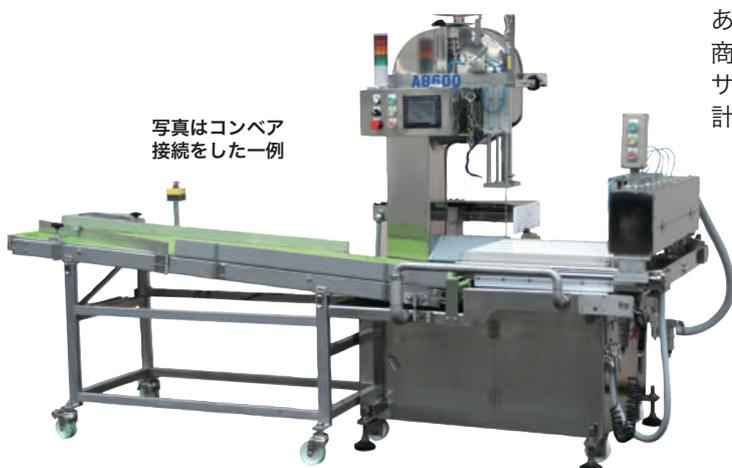
自動送り装置により、商材をセットして厚み幅を設定したら、あとは機械任せ。
