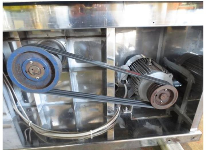
秋山機械のオーバーホールは電気部品など様々な部品を新品に交換し、さらに、特殊な薬品でフレームを洗浄します。
