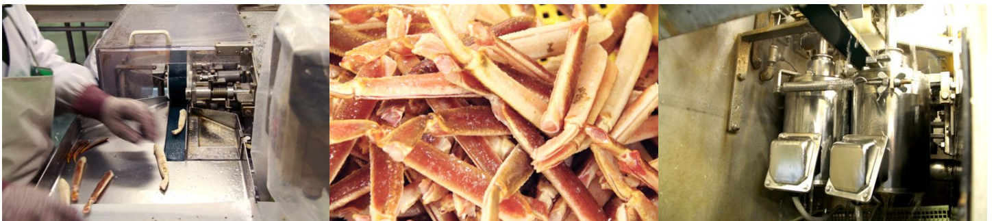
処理能力：カニ棒足（バルダイ種）200kg / 時間 最大切断サイズ :50×50mm
