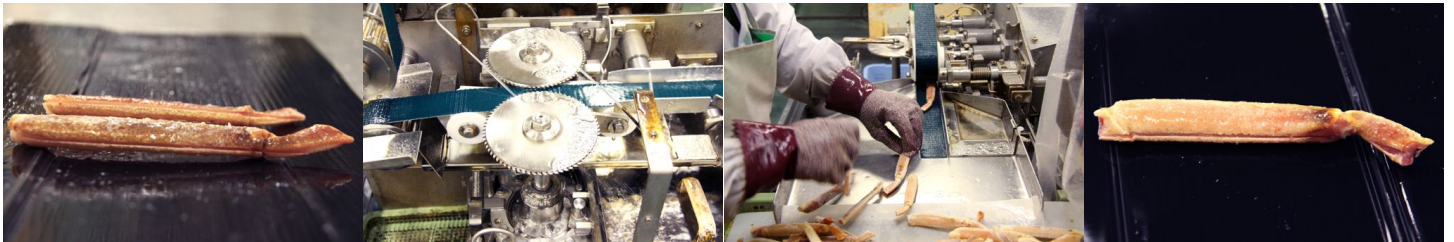
処理能力：カニ棒足（バルダイ種）200kg / 時間 最大切断サイズ :50×50mm
